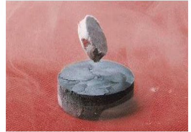
Imán levitando sobre un superconductor.
